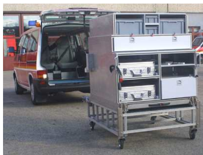
Das herausnehmbare Modul mit der medizingerätetechnischen Ausstattung.
