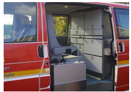
Ansicht des Innenraums mit eingeschobenem Gerätemodul.
